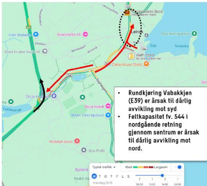
Figur 19 syner resultat av trafikkanalyse og utfordringar knytt til avvikling av trafikken.
